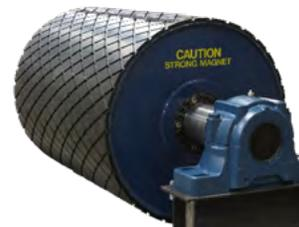
La polea magnética del IMT es un imán de fuerza industrial que garantiza una extracción de los metales atrapados en sistemas transportadores de correa. Las fuerzas magnéticas permanentes protegen los equipos transportadores, aumentan el tiempo de producción, reducen los costos de mantenimiento y aseguran productos sin metales o contaminantes féreos. Esta polea magnética se utiliza en una variedad de industrias como: reciclaje, agregados y recuperación de residuos.
